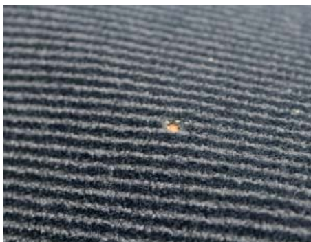
Brûlure sur une garniture de siège.
